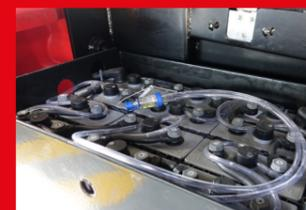
**Remplissage centralisé électrique**
