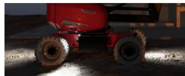
Pour éviter les collisions, pendant les opérations de nuit, la nacelle éclaire jusqu'à 8 mètres (modes auto-on-off).
