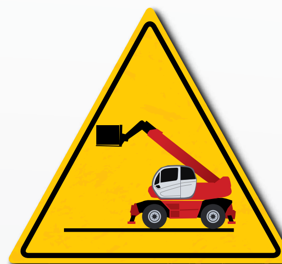
Non lasciare l'attrezzatura ferma con un carico sopraelevato
