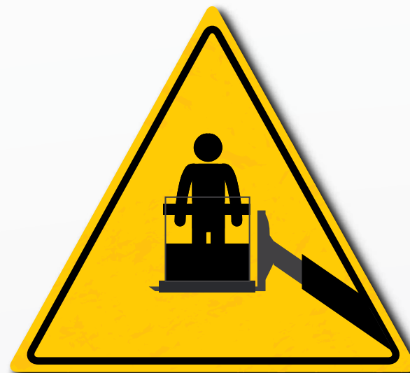
Personen dürfen nur mit geeigneten und zugelassenen Arbeitskörben angehoben werden
