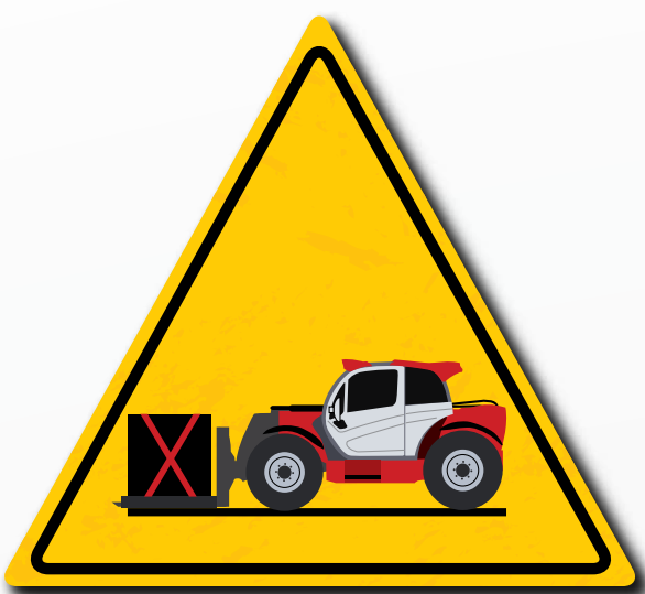
Sitúe la carga en una posición baja y con el brazo retraído
