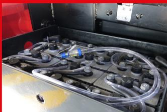
**Elektrisch, zentralisierte Batteriebefüllung**
