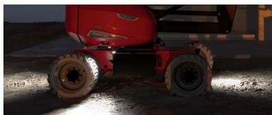
Zur Vermeidung von Zusammenstößen, leuchtet die Arbeitsbühne bei Nachteinsätzen bis zu 8 m aus (Lichtsensoren - automatisch ein/aus).
