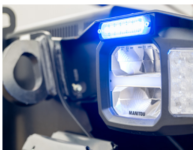
Rundum Signallicht Effektive 360°-Warnwirkung zur Absicherung des Fahrzeugumfelds.
