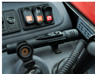
Kommunikation BOS Funk "Push to talk" & Freisprechanlage.
