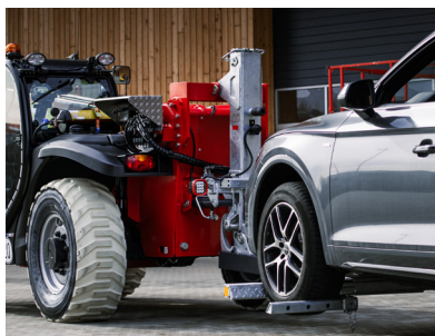
Hydraulische Abschleppbrille Havarierte PKW hydraulisch aufnehmen.
