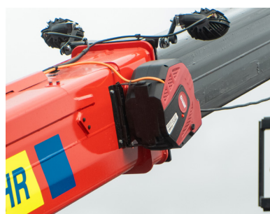
Kabeltrommel Flexible Stromversorgung mit robuster Führung für den Außeneinsatz.
