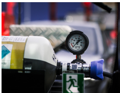
Autarker Atemschutz Druckluftflasche und Atemregler-Halterung fest integriert.
